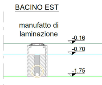
Figura 17 Sezione del bacino est con manufatto di laminazione in pozzetto 80x80 cm.
